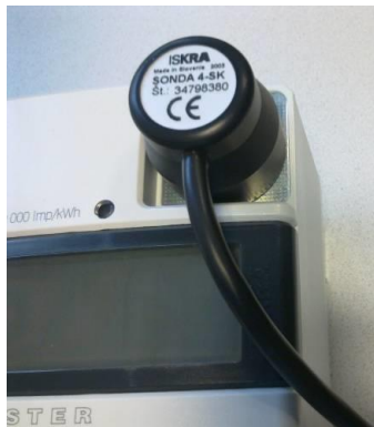
Bild 6: Anschluss der optischen Sonde an die INFO-Schnittstelle
