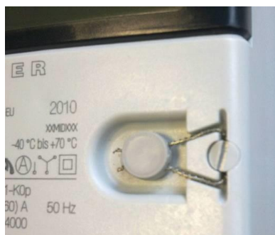
Bild 12: Sicherung des Plombierstiftes mit einer Drahtplombe
